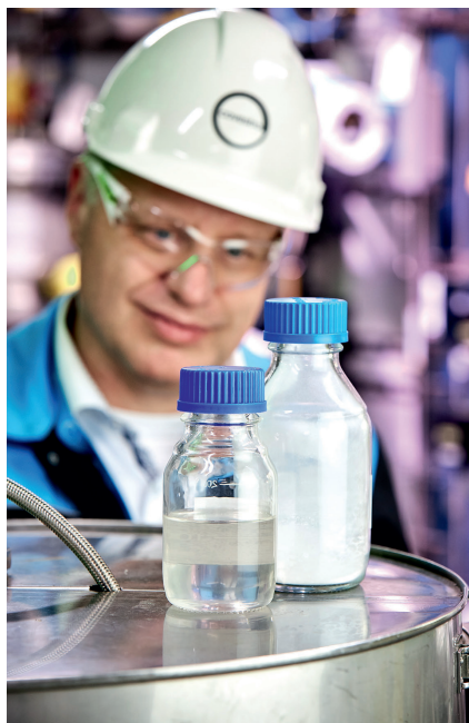
Bild 1. Bei dem unscheinbaren weißen Pulver in der hinteren Flasche handelt es sich um den Katalysator. Er macht die CO 2 -Reaktion zu Polyol (vorne im Bild) erst möglich (© Covestro)
